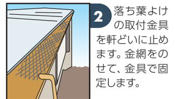
2 落ち葉よけの取付金具を軒どいに止めます。金網をのせて、金具で固定します。
