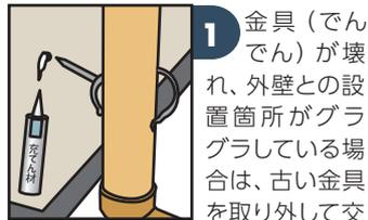
1 金具（でんでん）が壊れ、外壁との設置箇所がグラグラしている場合は、古い金具を取り外して交換します。外壁の穴から引き抜き、穴に充てん材を入れ、新しい金具で押し込むように取付けます。充てん材は外壁用を使用しましょう。
