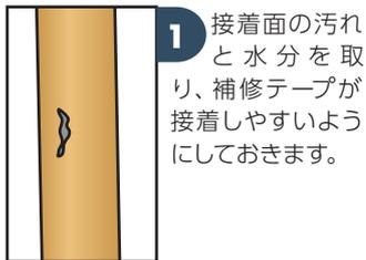
1 接着面の汚れと水分を取り、補修テープが接着しやすいようにしておきます。
