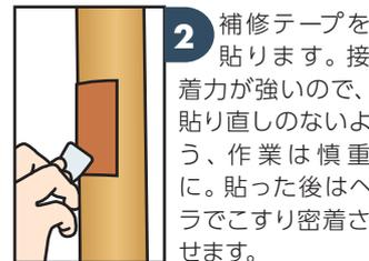
2 補修テープを貼ります。接着力が強いので、貼り直しのないよう、作業は慎重に。貼った後はヘラでこすり密着させます。
