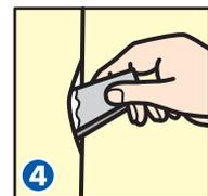
壁紙の継目がはがれて浮いている場合、細く切った名刺位の厚さの紙に補修用接着剤をつけ、浮いている
