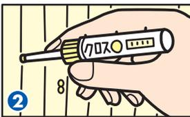
穴埋め材は壁紙に合う色を選び、ノズルを穴にあて、容器を軽く押して埋めます。壁紙に起伏があるときは、ノズルの先でデコボコに仕上げます。
