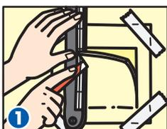
まず、柄の位置合わせをして、破れた部分よりもやや大きめのサイズに新しい壁紙を切っておきます。その壁紙を柄の位置をしっかりと合わせて布粘着テープで仮止めしておきます。カッターで、もとの壁紙と新しい壁紙を2枚一緒に、破れよりも大きめの四角形に切ります。切った部分の壁紙を2枚ともはがします。そこへ、壁紙補修用接着剤をつけた新しい壁紙を貼ります。
