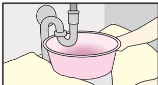
**2** 下のナットをゆるめる。プラスチック製のものは手だけで作業できるが、金属製の場合はウォーターポンププライヤーを使う。
